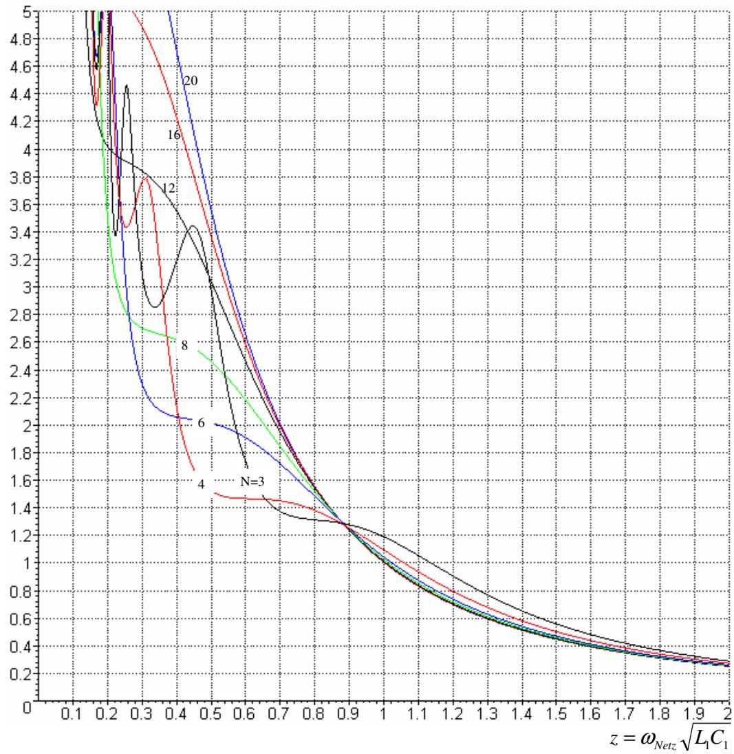
$\frac{i_{\text{trafo}}^{\text{eff}}}{u_0^{\text{eff}} \omega_{\text{Netz}} C_1}$  mit Blindstromkompensation
