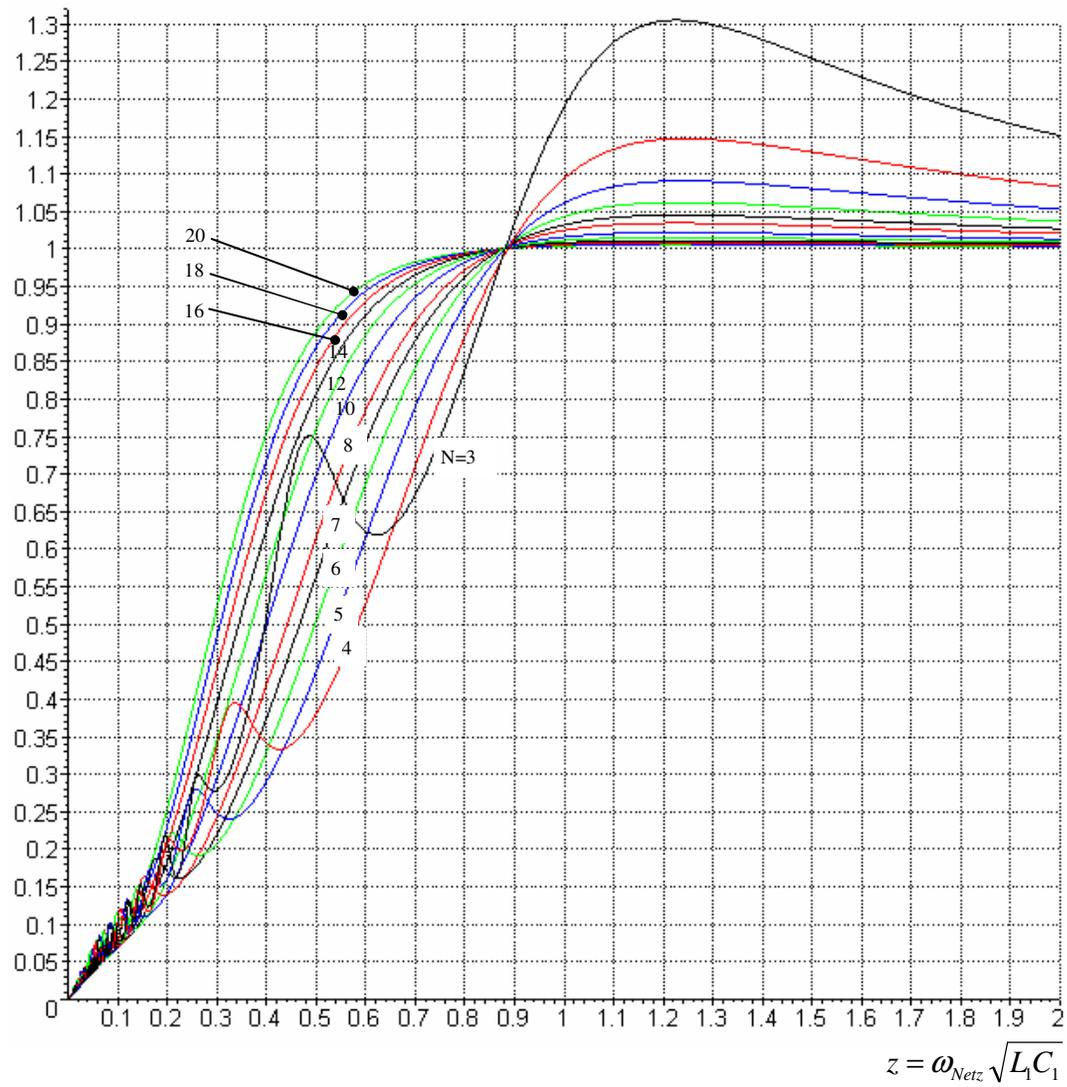
$\frac{i_{\text{rafo}}^{\text{eff}}}{u_0^{\text{eff}} / (\omega_{\text{Netz}} L_1)}$  mit Blindstromkompensation
